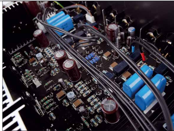
Die MM-/MC-Vorstufe ist wie alles in diesem Gerät diskret aufgebaut
