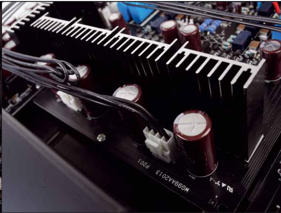
Kühlung ist reichlich erforderlich: hier für die Ausgangsstufen des DS Audio-Entzerrers
