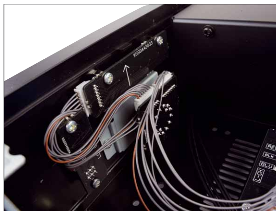
Digitaler als hier wird's nicht: Das ist der Impedanzwahlschalter von hinten
