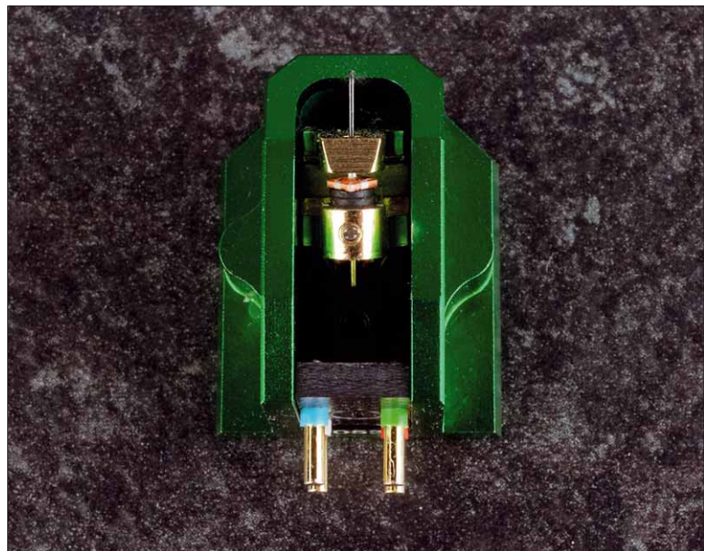
Der Generator weist bei den Systemen auch kleine Unterschiede beim Spulenmaterial und der Dämpfung auf
