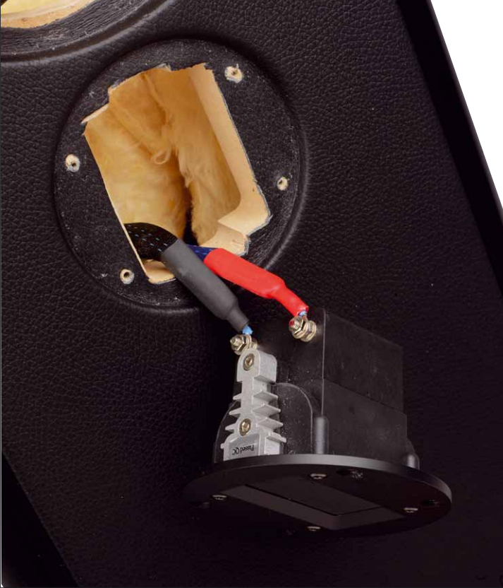
Der Hochtöner ist eine Sonderversion eines Fernost-Modells
